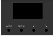
短按MODE键, 切换DMX解码器模式、调光器模式和RGB控制器模式三种工作模式。
