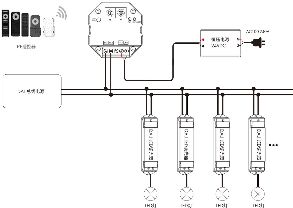
注意：建议为DALI主控使用24VDC电源供电，以减少DALI总线电源的负载。
